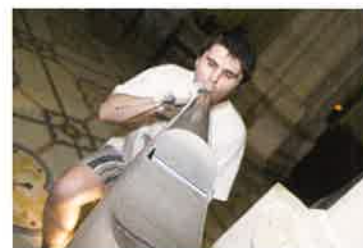
Harmonisation d'un tuyau de façade
