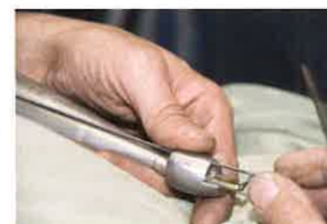
Mise en place de la rasette sur l'anche
