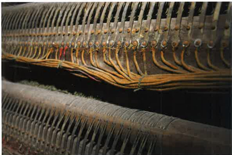
Barres d'accouplement de la transmission de 1888
