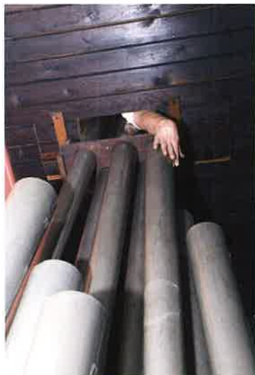
Ajustage d'un tuyau dans son "râtelier"
