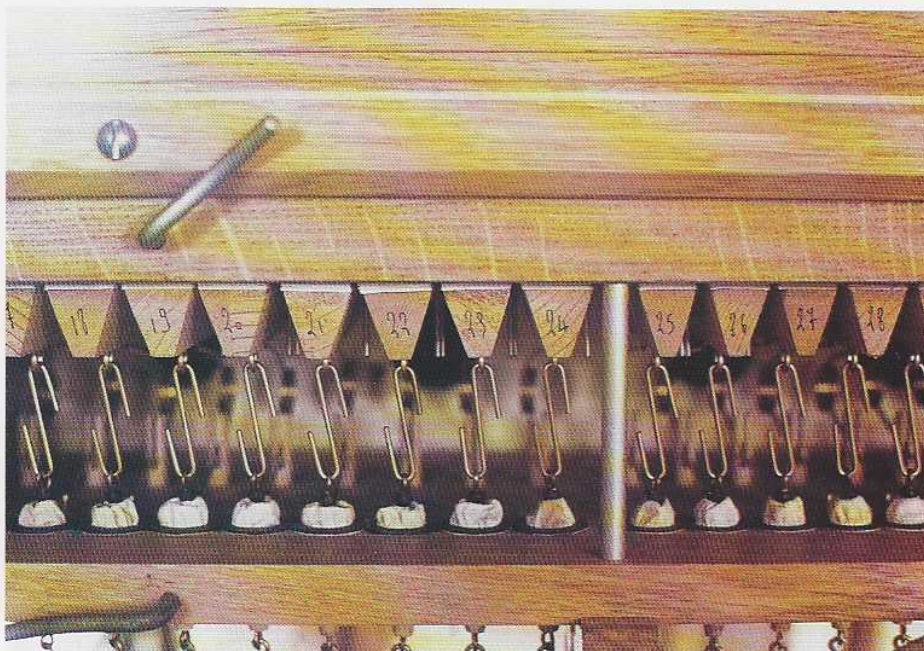
L'intérieur de la laye du récit : soupapes, esses, boursettes en peau d'agneau.
