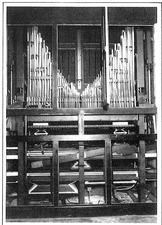
L'orgue de chœur, une fois retirés les panneaux à l'arrière. Au premier plan, le hautbois du récit.
