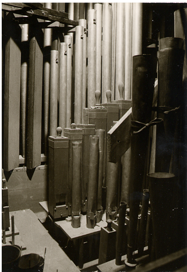
La console et trois vues de la tuyauterie du GO. Les jalousies de la boîte expressive étaient encore en arrière de la façade. En allant vers l'avant : Montre (en façade) Flûte traversière, Gambe, Bourdon, Prestant, chape vide, Flûte 4, Doublette 2, hautbois 8, Clairon 4.
