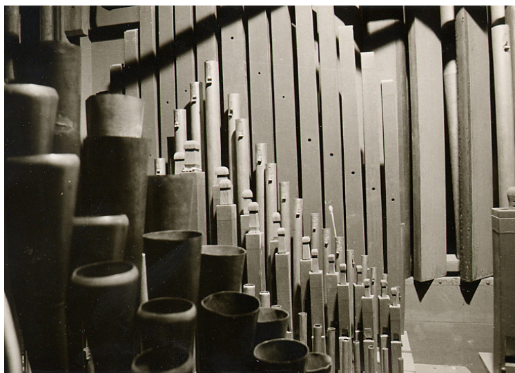
La console et trois vues de la tuyauterie du GO. Les jalousies de la boîte expressive étaient encore en arrière de la façade. En allant vers l'avant : Montre (en façade) Flûte traversière, Gambe, Bourdon, Prestant, chape vide, Flûte 4, Doublette 2, hautbois 8, Clairon 4.
