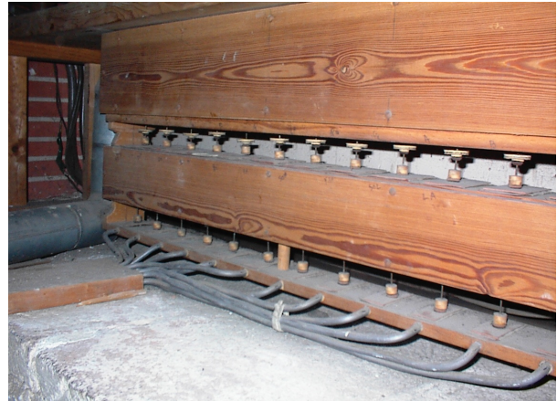
Mécanique à l'arrière de la console ; Membranes du sommier auxiliaires de la soubasse de 16
