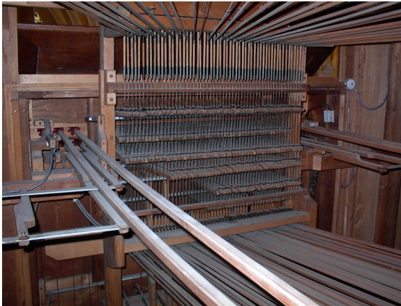
Mécanique à l'arrière de la console ; Membranes du sommier auxiliaires de la soubasse de 16
