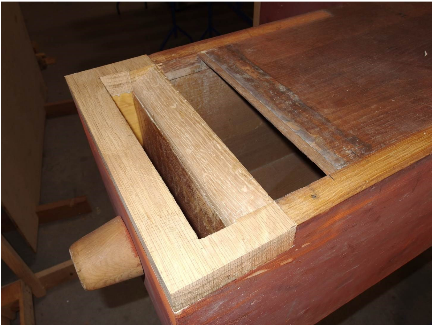
Réfection des blocs de la Flûte 16
