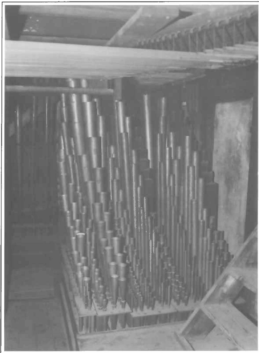
Saint-Médard - Le sommier et la tuyauterie du Positif, côté Ut
