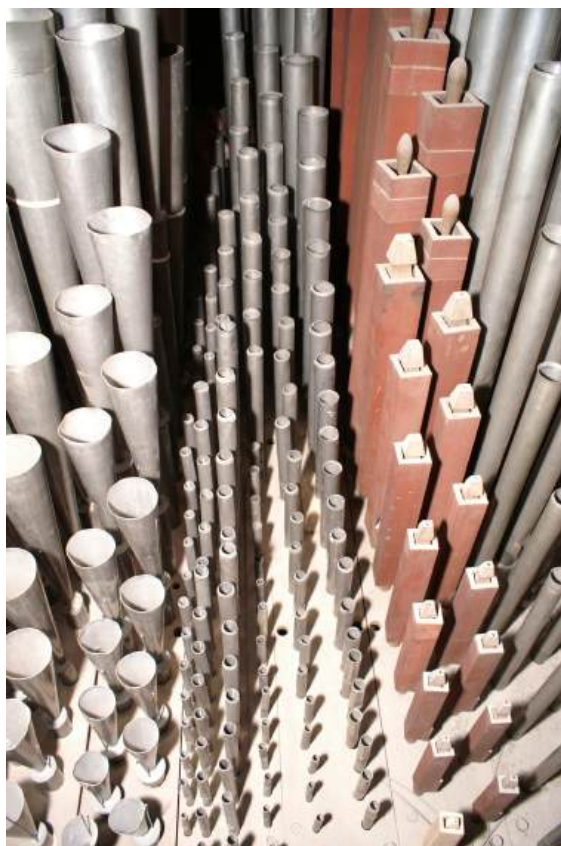
Tuyauterie de grand orgue on voit ici le Nazard disposé derrière le bourdon en bois
