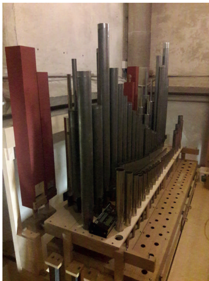
Montage de l'orgue, mise en place des tuyaux du récit.
