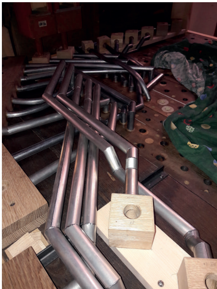
Montage de l'orgue, mise en place des postages, 2019
